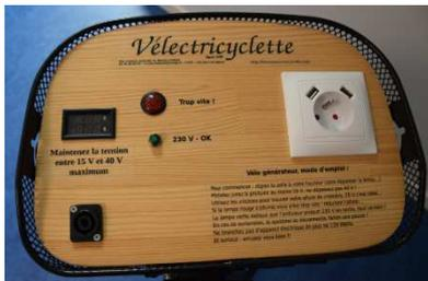
Il est possible de brancher sur la vélectricycllette des appareils électriques et un wattmètre.
